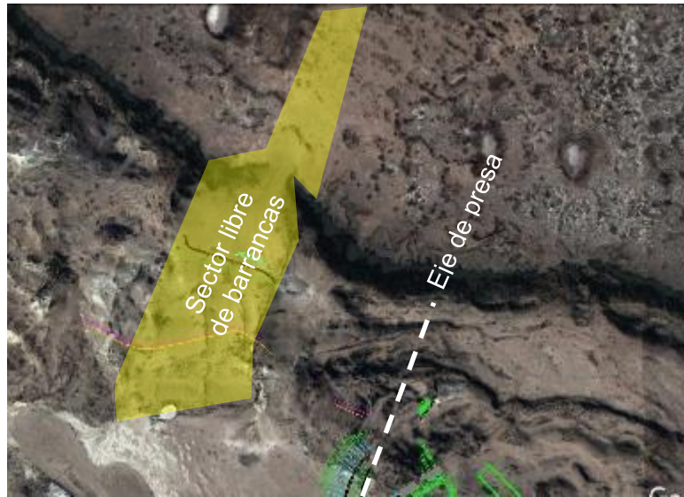
Figura 30. Sector por donde se desarrollará la traza del camino de acceso norte a la presa.
